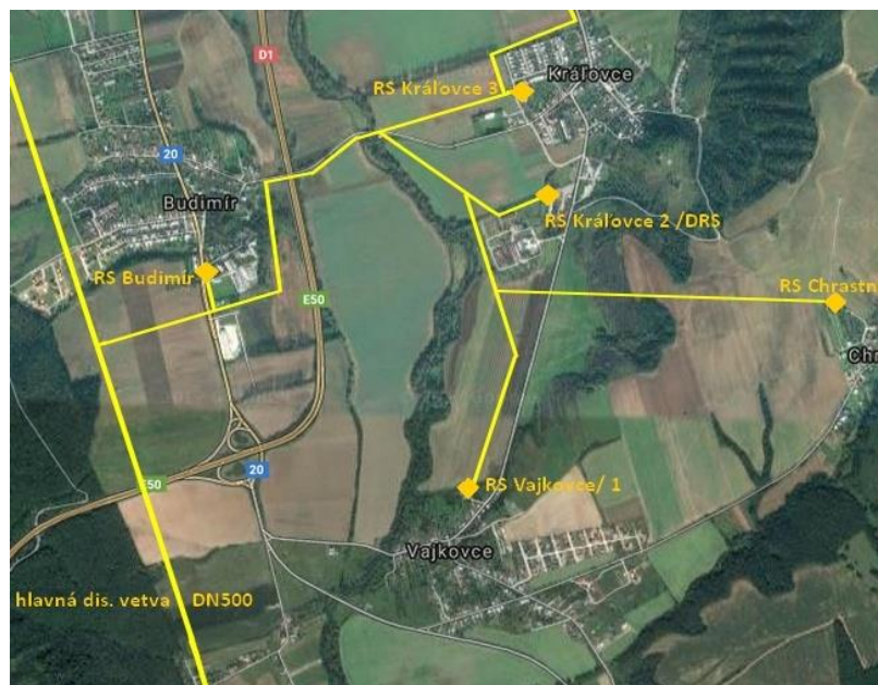
Figure 1. Gas distribution pipeline routing in the location of choice Slika 1. Usmjeravanje plinovoda na odabranoj lokaciji
