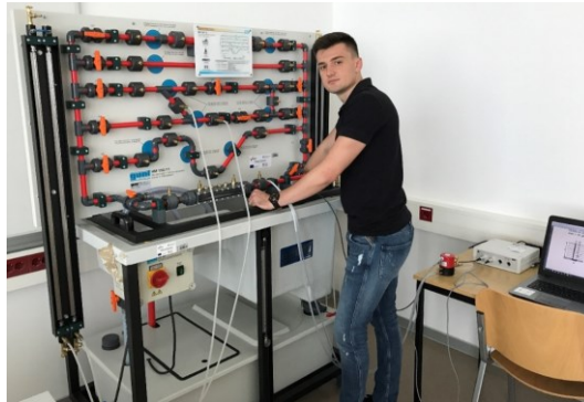
Slika 4. Mjerenja na fizikalnom modelu HM 150.11 (Foto: A. Karabegović)
