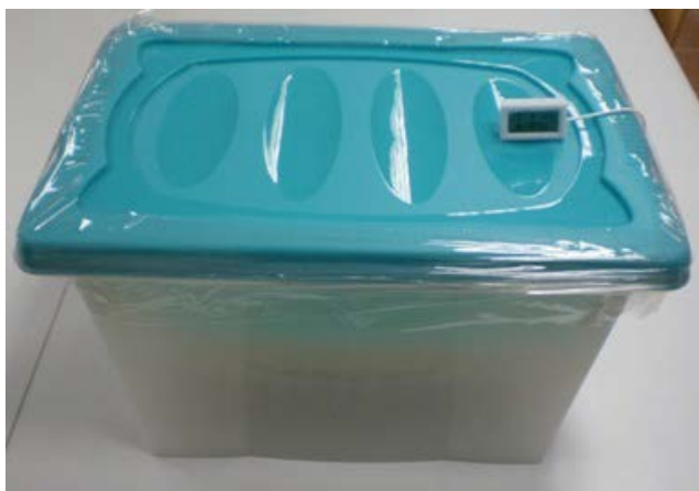
Slika 2. Posuda za kondicioniranje uzoraka s ugrađenim termo-higrometrom
