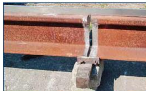
Slika 6. Određivanje kuta predeformacije tračnica pomoću ravnala Figure 6. Determination of predeformation angle on rails
