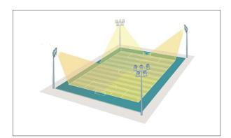
*Figure 4* Four Lighting Tower Arrangement [2] *Slika 4* Izvedba s četiri rasvjetna stupa [2]
