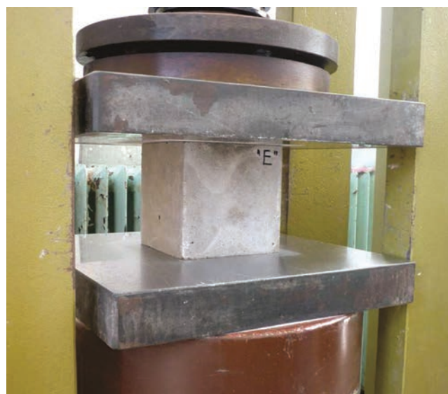
Slika 3. Ispitivanje tlačne čvrstoće
