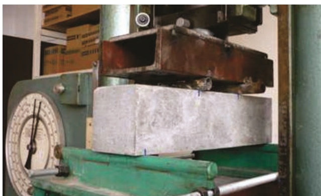
Slika 4. Ispitivanje vlačne čvrstoće pri savijanju
