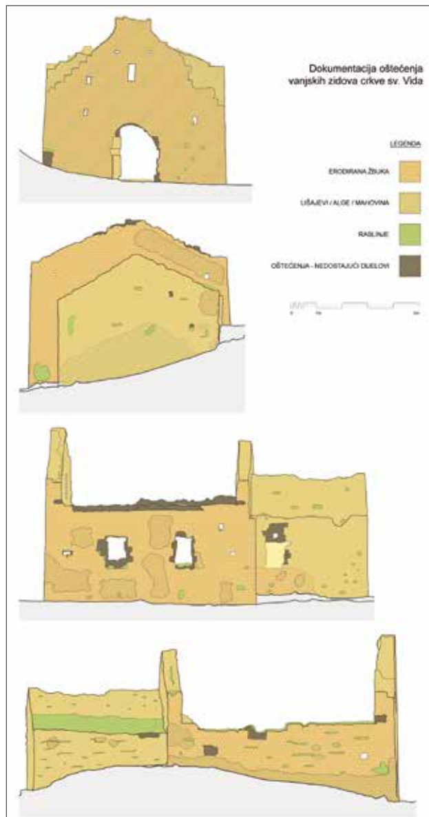
12 Dokumentacija oštećenja vanjskih zidova crkve sv. Vida, Vidovgrad (Dokumentacija HRZ-a)
