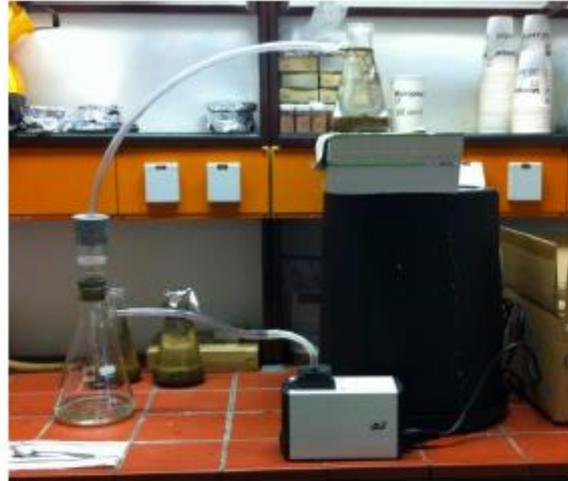
Abb.S8: Dichteseperation mit Vakuumpumpe nach KLEIN ET AL. 2015.
