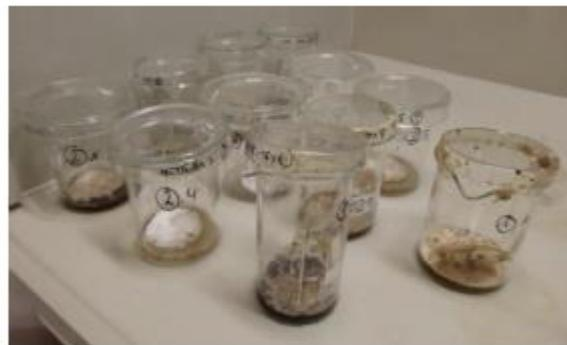
Abb. S10: Filter im Säurebad mit  $H_2O_2$  und  $H_2SO_4$ .
