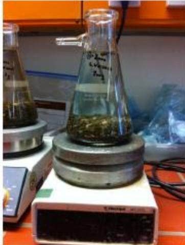
Abb.S7: Vorbereitung für Dichteseperation. 200g Probe in 500ml gesättigter NaCl-Lösung.
