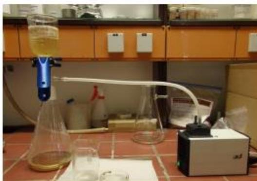
Abb. S11: Vakuum-Filtration nach Säurebad.
