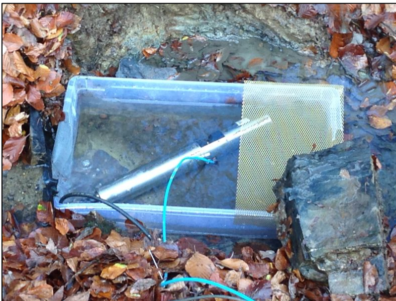
Foto 1: Eingebautes ProPS - UV Prozess Photometer im Vorfluter des Krofdorfer Forstes.
