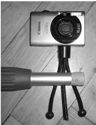
Abb. 3: Das an der Spitze des Teleskopstabs montierte Stativ mit aufgeschraubter Kamera.
