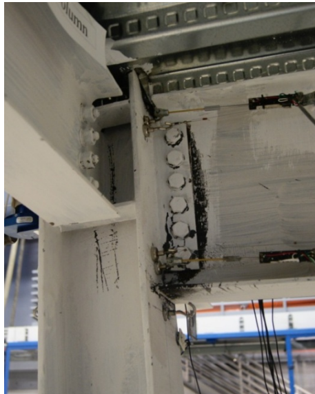
(d) Shear-Tab Conn. "A" [-0.069 rad.], HS02-200%
