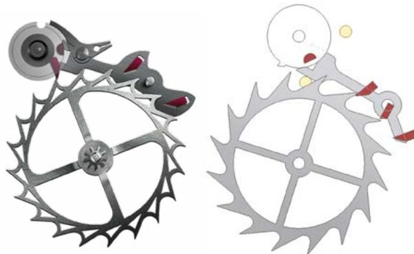
Fig. 2 : A gauche, l'échappement AP. A droite, le tracé de l'échappement IV.
