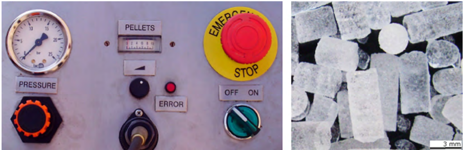
Figura 1. Detalle del panel de control de un equipo de limpieza criogénica (izquierda), y fotomacrografía de pellets de hielo seco (derecha).
