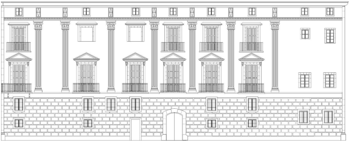
IMATGE 9: Alçat de l'estat actual de la façana del carrer de les Premses
