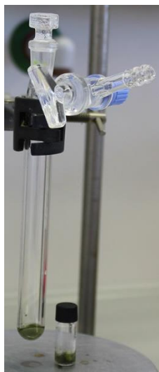
Abbildung 7.5. Reaktionsgefäße, die zur Dehydrierung von 14a getestet wurden, links: Schlenk-Rohr mit 7 mL Fassungsvermögen, rechts: Glasgefäß mit 1.5 mL Fassungsvermögen
