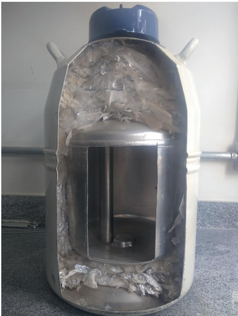
**Figura 7.** Estrutura do botijão criogênico vista em corte lateral.
