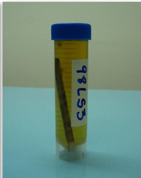
**Figura 25.** Saturação da bagueta em recipiente do tipo tubo Falcon contendo água para determinação da densidade básica da madeira.
