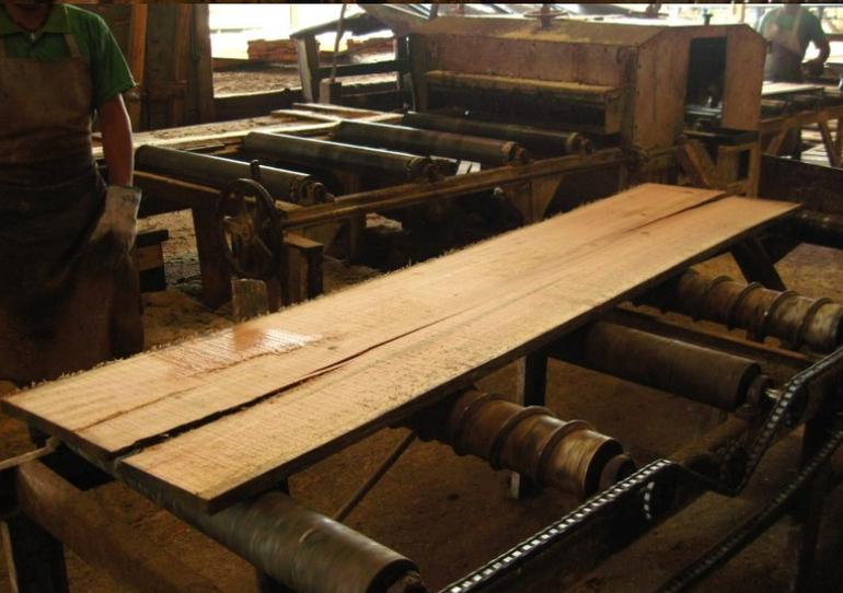
**Figura 33.** Tábua diametral recém obtida evidenciando as rachaduras ao longo de seu comprimento. Empresa Irani Madeiras, localizada em Irani, SC.
