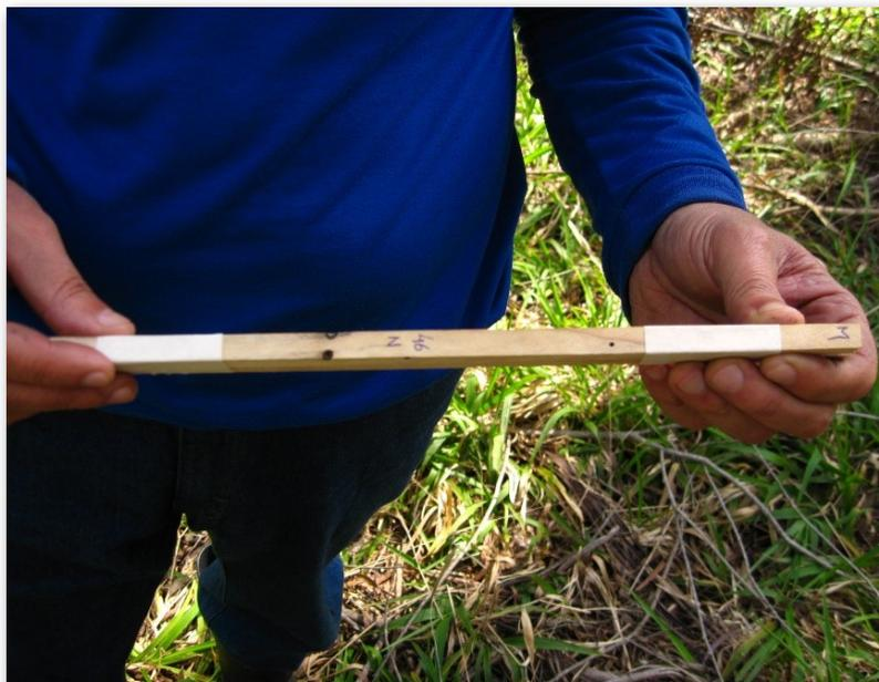
**Figura 24.** As duas partes do porta-amostras sendo firmadas por meio da aplicação de fita adesiva nas suas extremidades.
