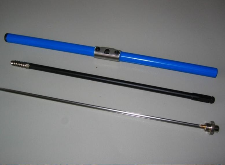
**Figura 20.** Componentes de trado de incremento utilizado para amostragem de lenho.
