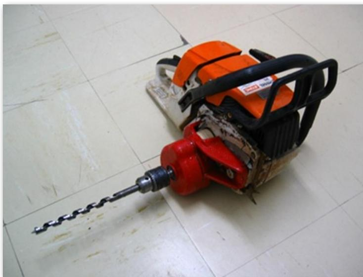
**Figura 26.** Conjunto formado por corpo da motosserra, no qual foi acoplado aparato auxiliar formado por mandril e broca, utilizado para realizar a amostragem de lenho para análise química.
