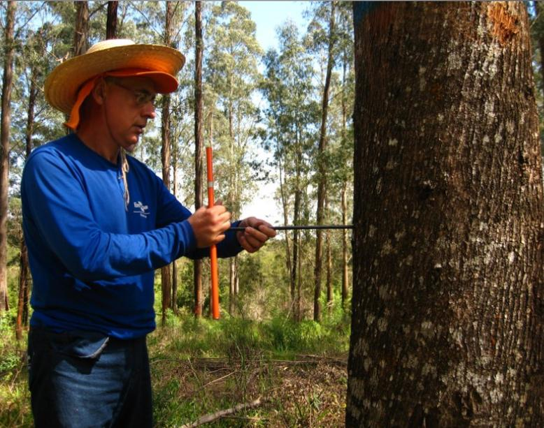
**Figura 21.** Definição do ponto, na altura equivalente ao DAP (1,30 m) da árvore, para início da perfuração com o trado de incremento para a extração da amostra de lenho.
