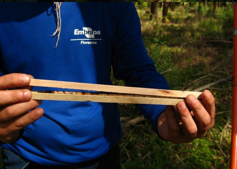
**Figura 23.** Posicionamento da segunda metade do porta-amostra sobre a bagueta.
