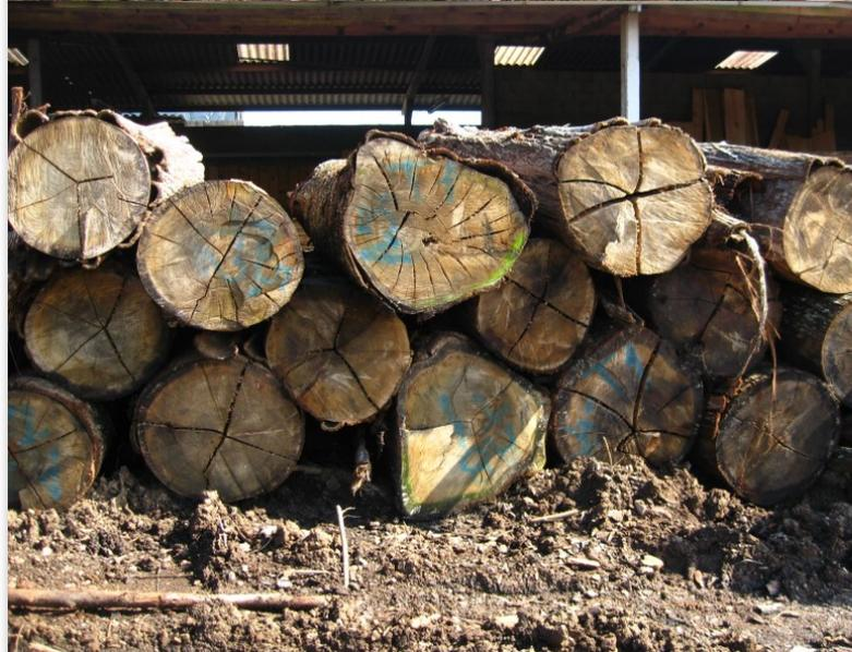
**Figura 31.** Definição da posição do pranchão diametral na extremidade da tora para orientar o corte e respectiva identificação. Empresa Irani Madeiras, localizada em Irani, SC.
