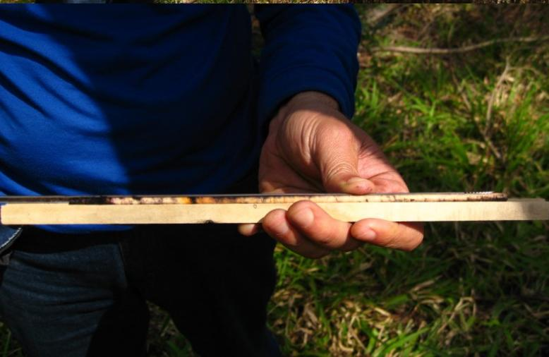
**Figura 22.** Bagueta extraída da árvore sendo inserida no sulco do porta-amostra para proteção durante o transporte ao laboratório.
