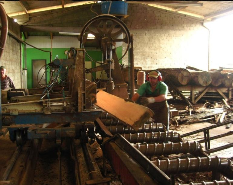
**Figura 34.** Momento em que o corte do pranchão diametral é completado na serra fita simples após giro de 90° da tora. Empresa Irani Madeiras, localizada em Irani, SC.
