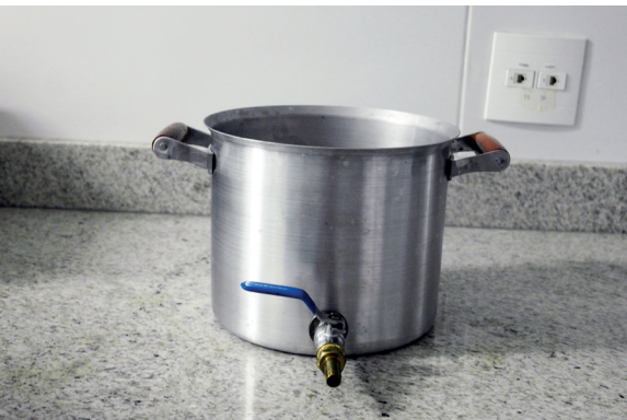
Figura 4. Tanques de alumínio de 3 L dotado de válvula na parte inferior.
