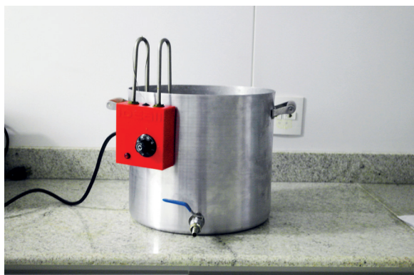
Figura 2. Tanque de alumínio de 10 L dotado de válvula na parte inferior.
