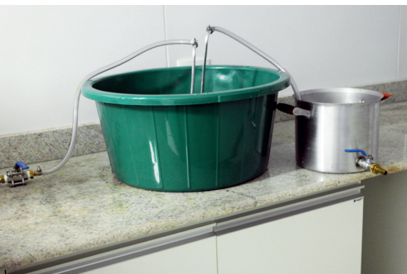
Figura 18. Segmentos de mangueira conectando a saída da válvula (9) à haste de entrada do chiller (10) do estágio de refrigeração e a haste de saída deste chiller ao tanque (11).
