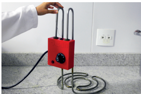
Figura 3. Resistência elétrica de 10 A, com variação de temperatura de 50 °C a 300 °C dotada de um termostato.
