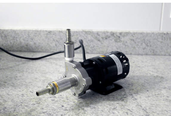
Figura 5. Bomba centrífuga sanitária com 16 W de potência.
