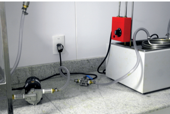
Figura 13. Segmentos de mangueira conectando a saída da bomba (3) à entrada da válvula (4) e a saída desta à haste de entrada do chiller (5) do estágio de aquecimento.
