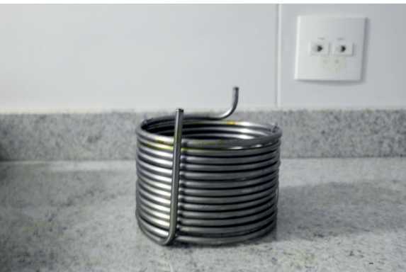
Figura 7. Chiller cilíndrico de aço inox.
