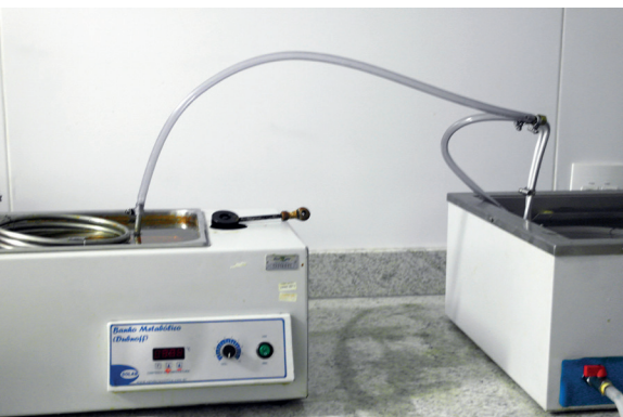
Figura 14. Segmento de mangueira conectando a saída do chiller (5) do estágio de aquecimento à entrada do primeiro chiller do estágio de manutenção de temperatura.
