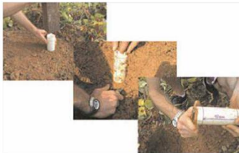
Figura 2. Retirada e preparo de amostra de solo para determinação de sua densidade.
