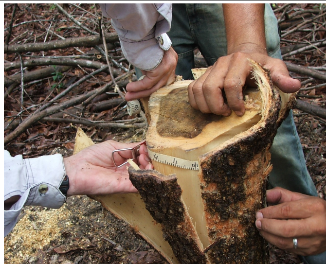
Fig. 3. Marcação das posições de medição (A), medição do diâmetro com (B) e sem casca (C).
