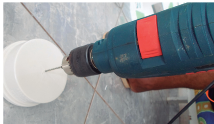
Figura 80. Caps de 100mm sendo perfurado ao centro.
