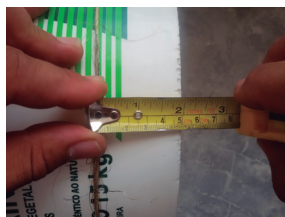
Figura 70. Marcação de 10cm a partir do fundo do balde.
