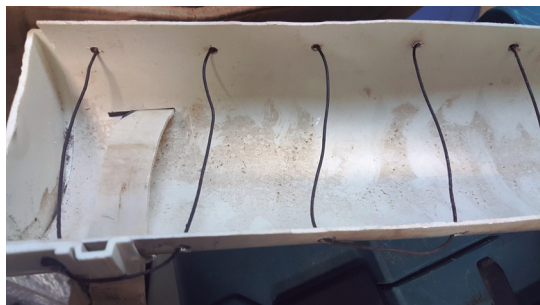
Figura 63. Furos realizados no cano de PVC, com passagem do arame.
