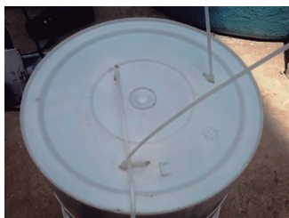
Figura 94. Abraçadeiras usadas na fixação do cano, para serem retiradas.
