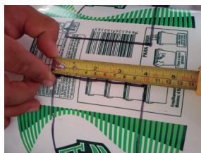
Figura 72. Marcação de mais 5cm a partir da medida anterior.
