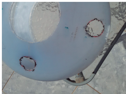
Figura 47. Locais dos bocais perfurados no garrafão.
