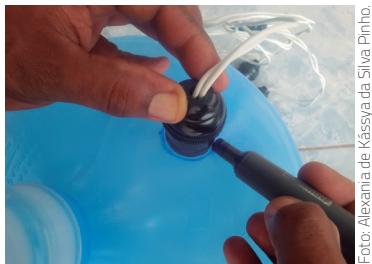
Figura 44. Marcação dos bocais no garrafão.
