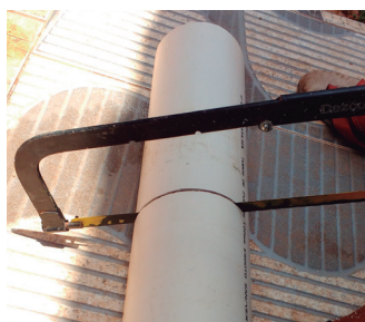
Figura 111. Cano sendo cortado para a confecção dos pés.
