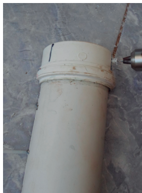
Figura 60. Caps sendo afixado ao cano.
