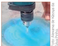
Figura 9. Broca perfurando o fundo do garrafão.
