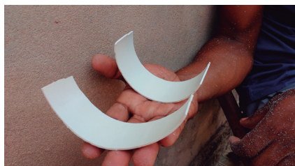
Figura 112. Pedacos de cano PVC que serão cruzados na elaboração dos pés.
