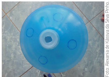
Figura 45. Locais dos bocais marcados no garrafão.
