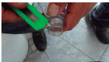
Figura 98. Área rosqueável da garrafa sendo retirada.
