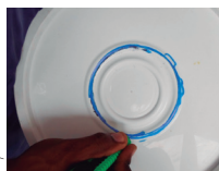
Figura 87. Marcação na tampa sendo cortada com auxílio de estilete.
