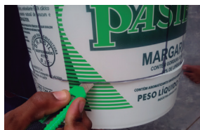
Figura 76. Balde marcado sendo cortado por estilete.
