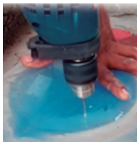
Figura 24. Fundo do garrafão sendo perfurado por furadeira e broca.
