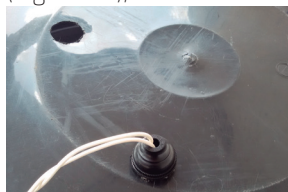
Figura 39. Buracos na bacia e bocal sendo afixado.
