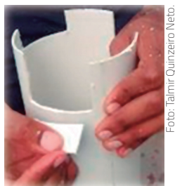
Figura 91. Cortes retangulares na extremidade do cano.
