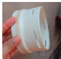
Figura 115. Cano alargado e cortado para receber os pés.
