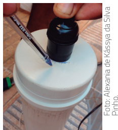
Figura 120. Marcação com caneta no caps, do tamanho do bocal.
