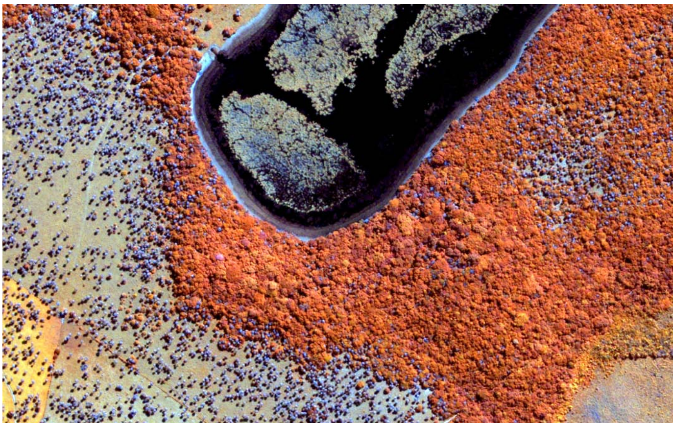
Figura 5. Imagem WV-2, composição falsa cor RGB 631, representa em tons de azul os butiazeiros, e em tons de vermelho as demais espécies arbóreas de ocorrência na área. Organização: Fábria Amorim da Costa.
