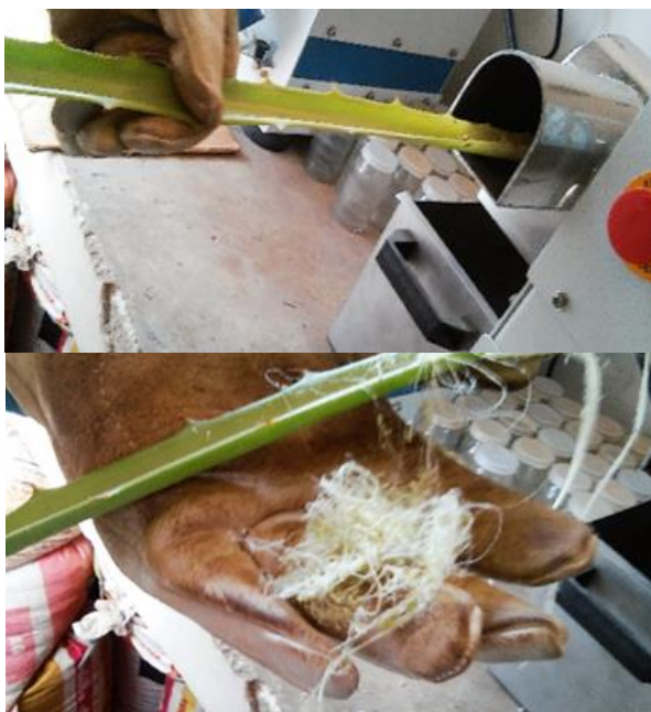
Figura 3. Processo de extração de fibra do gravatá.
