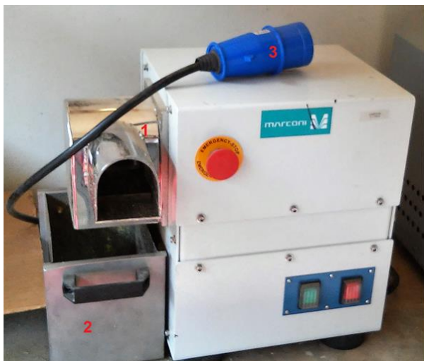
Figura 2. Desfibrador mecânico comercial de cana-de-açúcar MARCONI modelo MA 081. Destaque de partes componentes do desfibrador (1. Câmara de desfibramento em aço inox AISI 304. 2. Caixa de saída do material desfibrado. 3. Cabo de energia trifilar (duas fases e um terra), com dupla isolamento, com plug de três pinos, NM 243 e NBR 14136).
