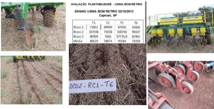
**Figura 3.** Resultado da avaliação do estande inicial dos testes com a semeadora-adubadora COP CA, da Marchesan, na Usina Bom Retiro, em Capivari-SP, 2013.
