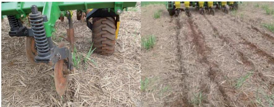
**Figura 5.** Detalhe da semeadora COP CA, com o sistema de corte de palhada de cana com discos de 24 polegadas, o sulcador de preparo do solo e o semeio do sorgo sacarino em uma área com alto volume de palha (Foto: Evandro Chartuni Mantovani, 2014).
