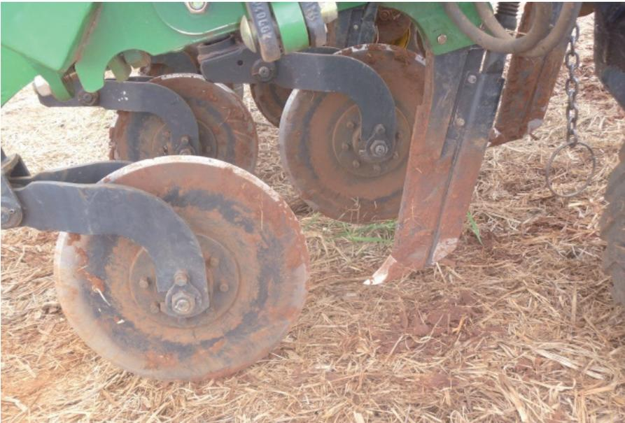
**Figura 7.** Detalhe da haste sulcadora, da semeadora-adubadora COP CA, para testes finais no campo. (Foto: Evandro Chartuni Mantovani, 2014).
