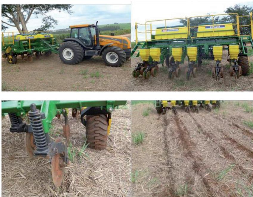
**Figura 1.** Detalhe da Semeadora COP CA, com o sistema de corte de palhada de cana com discos de 24 polegadas, o sulcador de preparo do solo e o semeio do sorgo sacarino em uma área com alto volume de palha. (Foto: Evandro Chartuni Mantovani, 2012)
