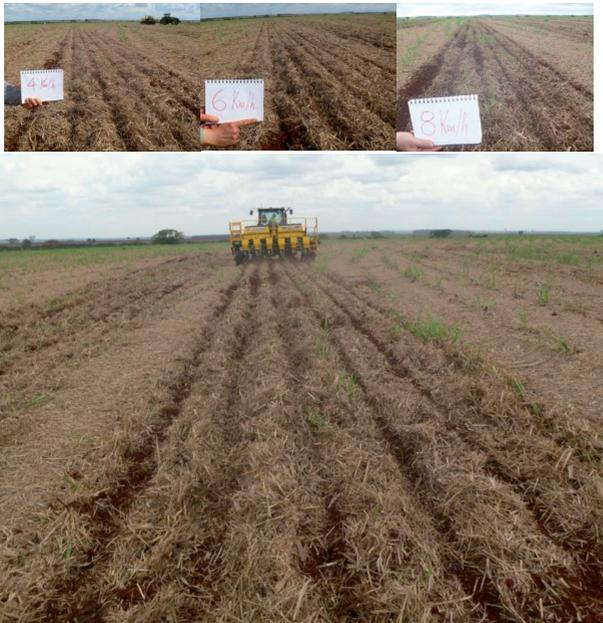
**Figura 11.** Detalhe da área trabalhada com haste escarificadora e Limpador de Rua ou “Row Cleaner”, com espaçamento de 60 cm, em alta densidade de palhada, em três velocidades de trabalho, 4, 6 e 8 km/h, durante os testes na área experimental, da Usina Bom Retiro, em Capivari-SP, 2014. (Foto: Evandro Chartuni Mantovani, 2014).
