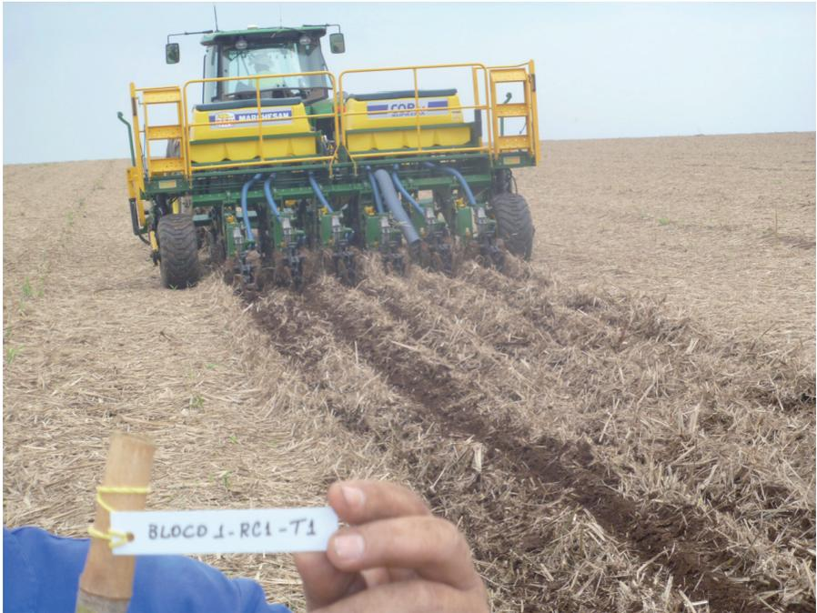
**Figura 6.** Teste da semeadora-adubadora COP CA, sob palhada de alta densidade, com espaçamento entrelinhas de 0,50 m e acúmulo de material entre os carrinhos. (Foto: Evandro Chartuni Mantovani).
