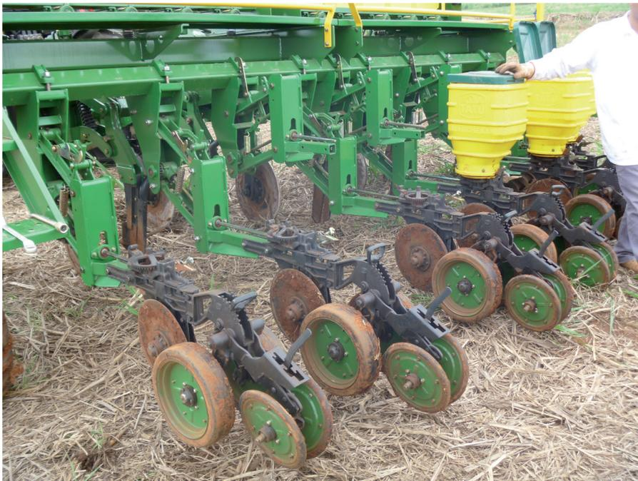
**Figura 2.** Detalhe do sistema de distribuição de sementes, com os discos desencontrados de abertura da linha de semeadura, com rodas laterais de controle de profundidade e atrás, a roda compactadora de borracha, em V, utilizada nos testes de campo, na condição de semeadura direta, em áreas com alta quantidade de palhada de cana-de-açúcar. (Fotos: Evandro Chartuni Mantovani, 2012)
