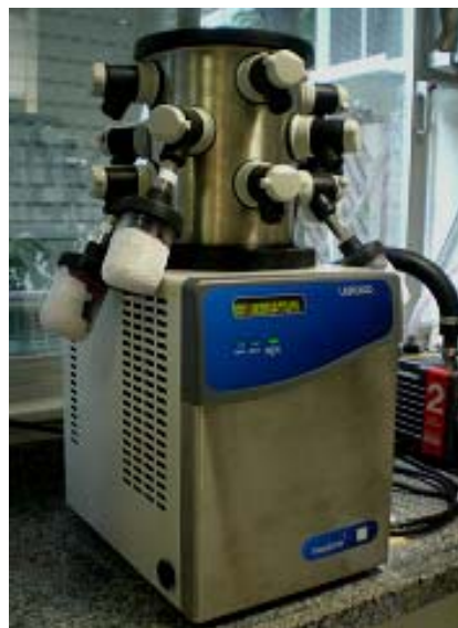
Fig. 1. Liofilizador utilizado para a obtenção das microcápsulas de suco de uva.
