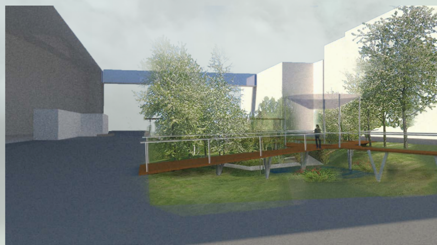
PERSPEKTIV ÖVER ENTRÉTORGET. GLASTAKET VID UTIKISPLATSEN SAMLAR UPP REGNVATTEN SOM LEDS NER TILL DAMMEN, LIKT ETT VATTENFALL. BROAR, RÄCKEN OCH GLASTAKET LYES UPP NÄTTEID.
