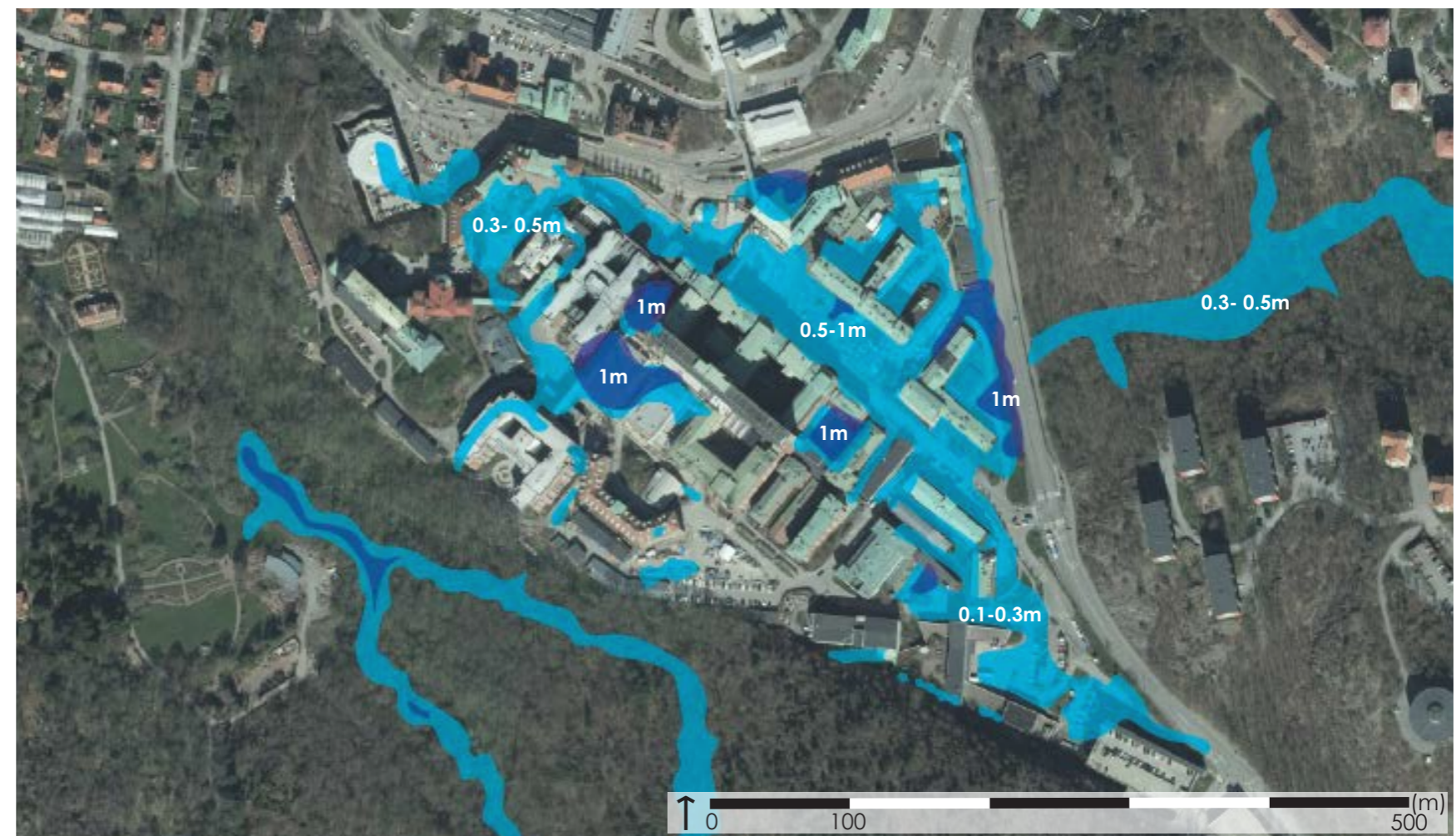
FIGUR 2: BILDEN VISAR HUR SAHLGRENSKA UNIVERSITETSSJUKHUSET ÖVERSVÄMMAS VID ETT 100-ÅRSREGN. ORTOFOTO © LANTMÄTERIET, YTOR AVRITADE FRÅN VATTENIGOTEBORG.SE, SKYFALL- 100 ÅRSREGN.
