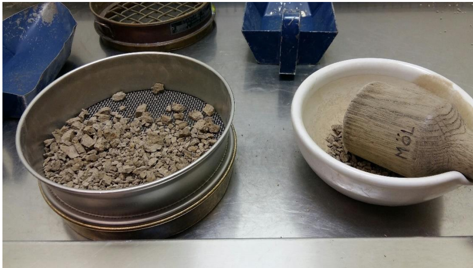
Figur 5. Malning och siktning av de insamlade jordproverna. På fotot mortlas aggregat sönder och siktas genom en 2 mm-sikt. Foto: Hanna Falk
