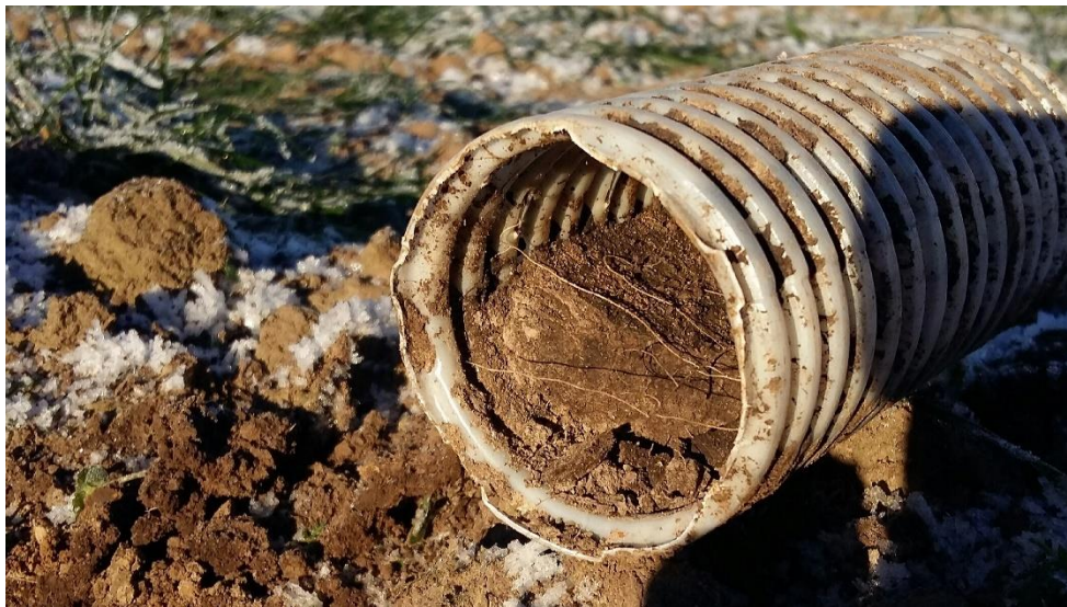
Figur 7. Organiskt material i form av växtrötter inuti dräneringsledning 1. Foto: Hanna Falk
