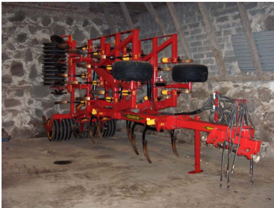
Figur 2. Väderstad Cultus, utrustad med varianten gummirulle som packvält.
