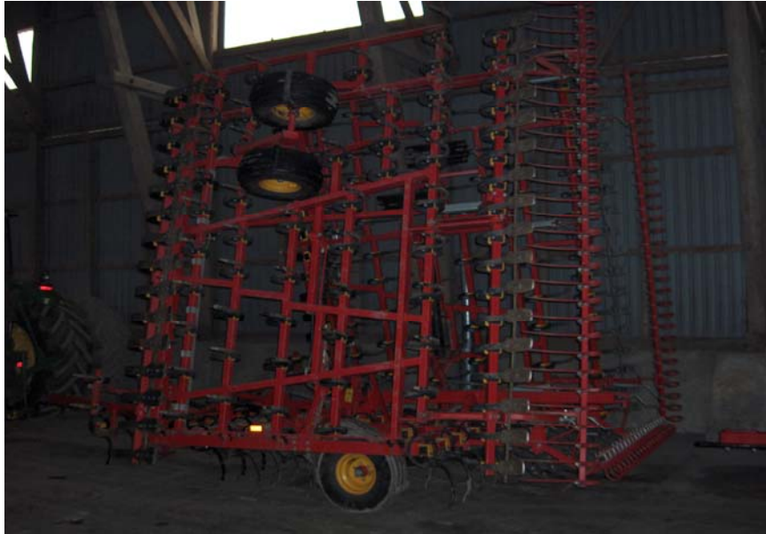
Figur 3. Väderstad Harv NZA-Aggressiv, utrustad med dubbla sladdplankor.
