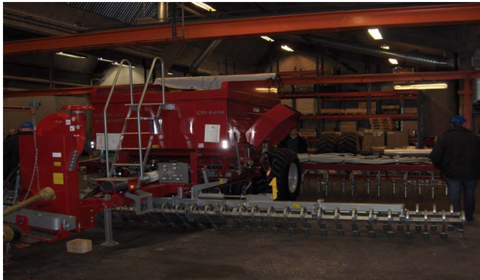
Figur 6. Överums demeter kombijet, utrustad med multi-flex systemet
