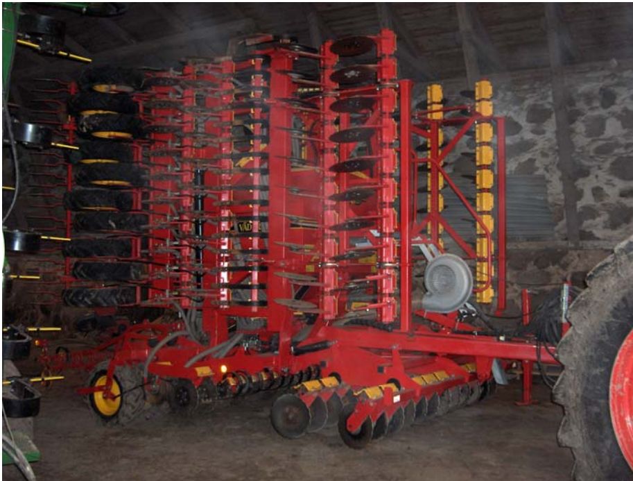
Figur 5. Väderstad rapid, utrustad med system disc. (Ej kombiutförande).
