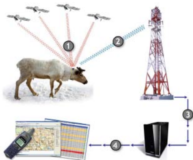
Figur 2:1. Schematisk beskrivning av GPS-positionering, kommunikation och realtidsvisning av renarnas positioner enligt Sandström & Wedin, 2007, s. 12.
