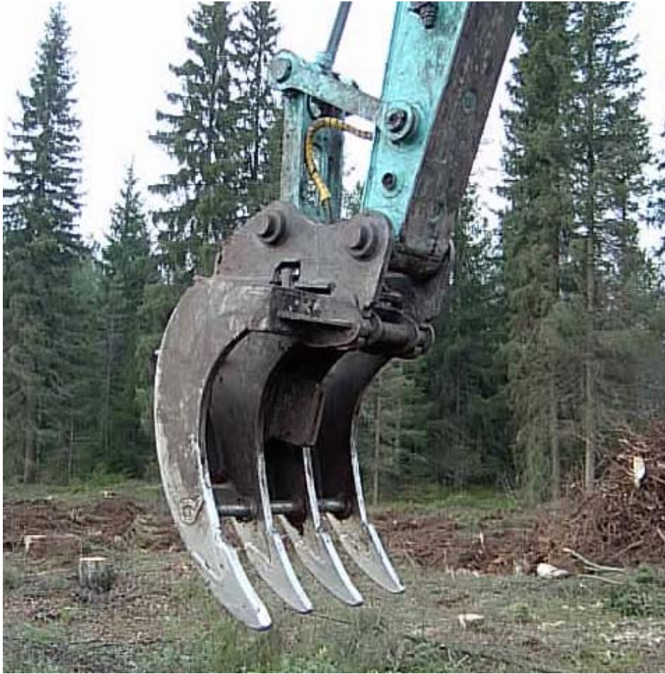
Figur 7. En version av Altogrepen (Foto Nordfjell). Figure 7. One version of Alto stump harvester.
