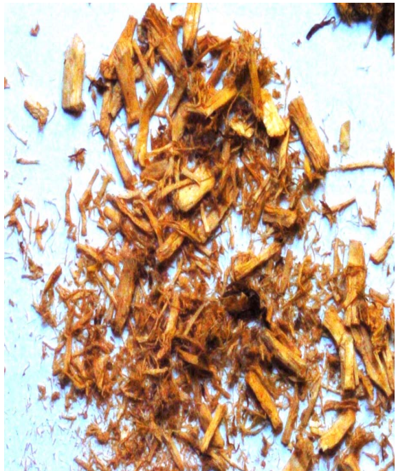
Figur 10. Raffinerat spån (G3) före pelletering och spån i färdig pellet G3H. Figure 10. Refined sawdust ( G3) before pelletizing and sawdust in corresponding pellet.
