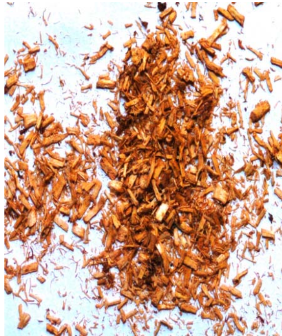
Figur 9. Raffinerat spån (G1) före pelletering och spån i färdig pellet G1H. Figure 9. Refined sawdust G1 before pelletizing and sawdust in G1H pellet.
