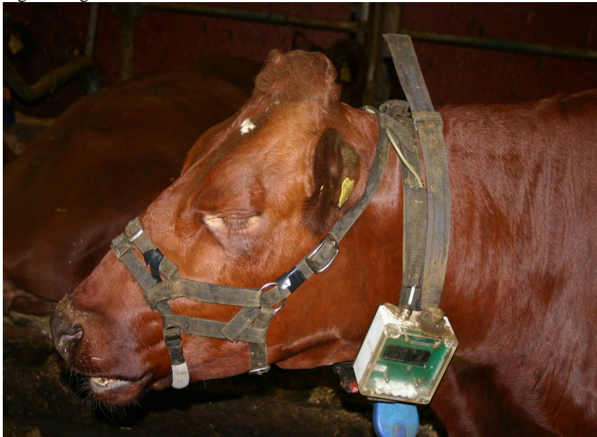
Bild 3. IGER behaviour recorder (Ultra sound advice, London, UK), beskriven av Rutter et al (1997) för registrering av käkrörelser.
