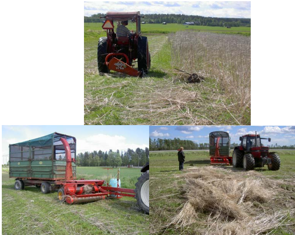
Figur 10. Dessa foton kommer från Röbbäcksdalen där man odlar den korta oljehampan Finola. Överst: Fällning med dubbelkniv. Underst: Hackning med Taarup exakthack Foto: Michael Finell
