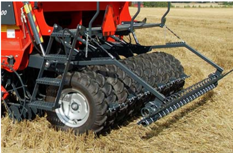
Fig. 5. De större bärhjulen med traktormönster och efterföljande harv. (AGCO AB, 2004)
