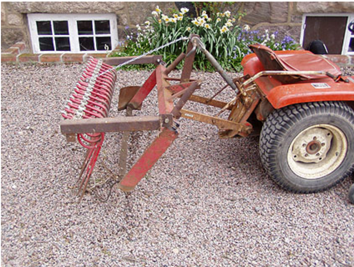
Figur 61 Trädgårdstraktorn har försetts med skyffeljärn och efterharv. Konstruktör Lars Brunnström. (Foto: Åse Brunnström, 2004)
