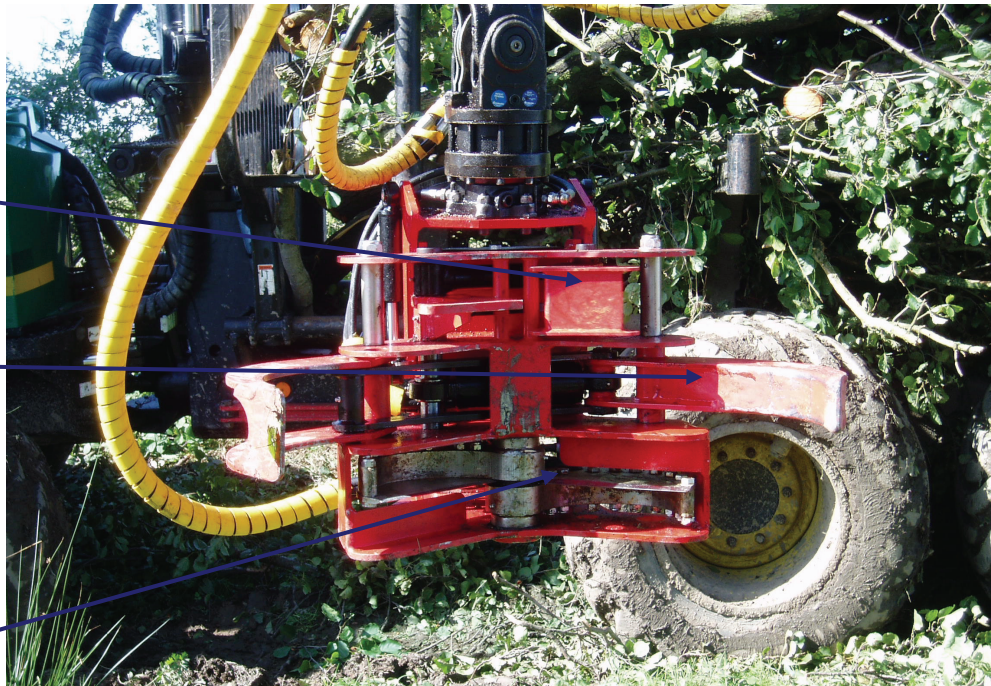
Figur 4. Klippaggregatet under premiärkörningen september 2007. Klippknivarna på bilden är i öppet läge. (Foto, Fredrik Dahl).
