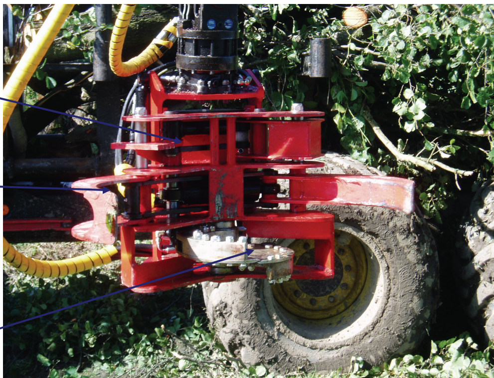
Figur 5. Klippaggregatet under premiärkörningen september 2007. Klippknivarna på bilden är i stängt läge. (Foto, Fredrik Dahl).
