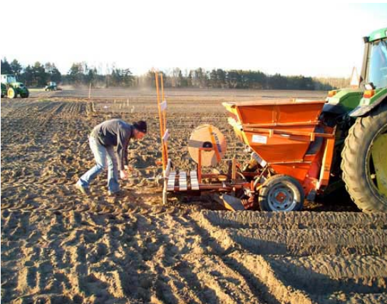
Figur 3. Här läggs slangen, gödningen och sättknölen ner i drillen, gödningen lades med en frontmonterad radmyllare, ej synlig på bilden.
