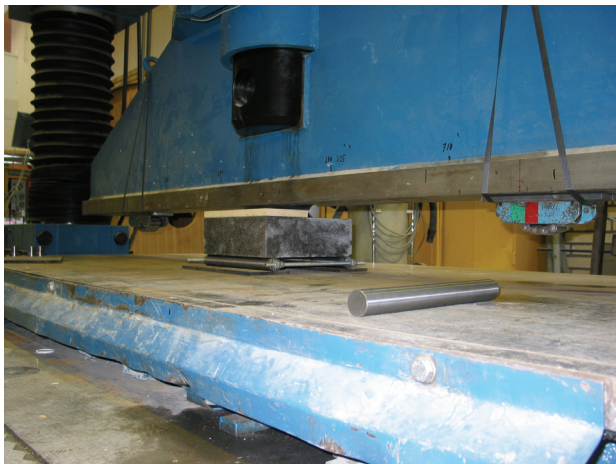
Figur 11. Stora provningsmaskinen uppriggad för trepunktsbelastning.
