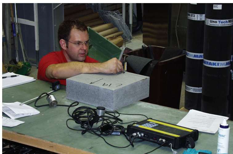
Figur 8. Mätning av provkropp. I bild syns även utrustning för ultraljudsmätning (Foto: Björn Schouenborg, SP).
