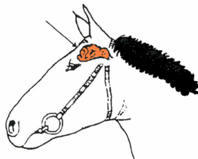
Figur 8, placering av bultpistol
