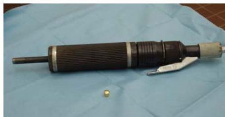
Figur 6, utskjuten bult och krutladdning
