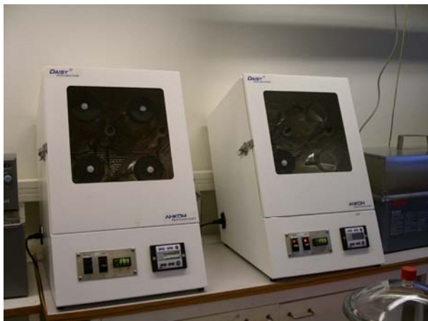
Figur 6. Utrustning för in vitro -inkuberingen: ANKOM Daisy II in vitro -inkubatorn.
