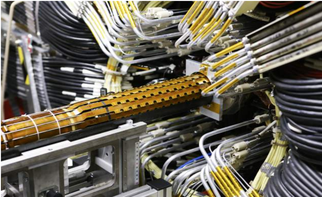
Figura 1.5: Istantanea delle delicate fasi di inserimento di Insertable Barrel Layer , il nuovo strato di detector di ATLAS, attorno ad una nuova beam pipe che è stata opportunamente sagomata per permettere di alloggiare IBL dentro il Layer-0.
