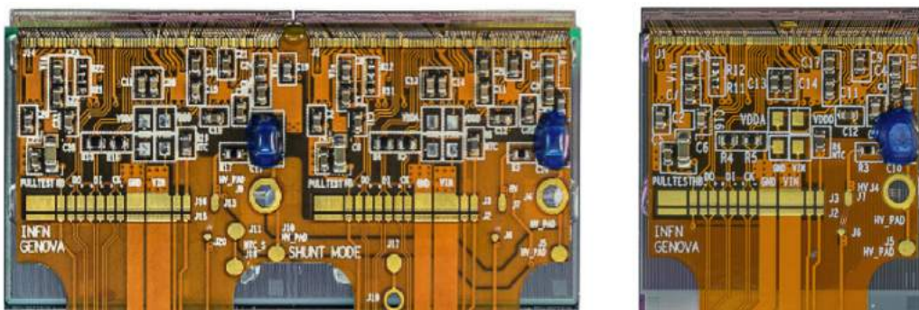
Figura 1.6: Nuovi sensori[15] inseriti con IBL a diversa tecnologia: planare (a sinistra) contenenti 160 \times 336 pixel e 3D (a destra) da 80 \times 336 pixel.
