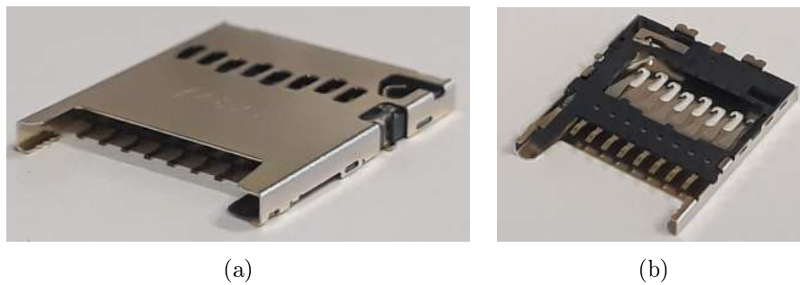
Figura 3.19: Socket MOLEX 5040771891 visto dal lato dello shield esterno (a) e dal lato dei contatti con la microSD (b).
