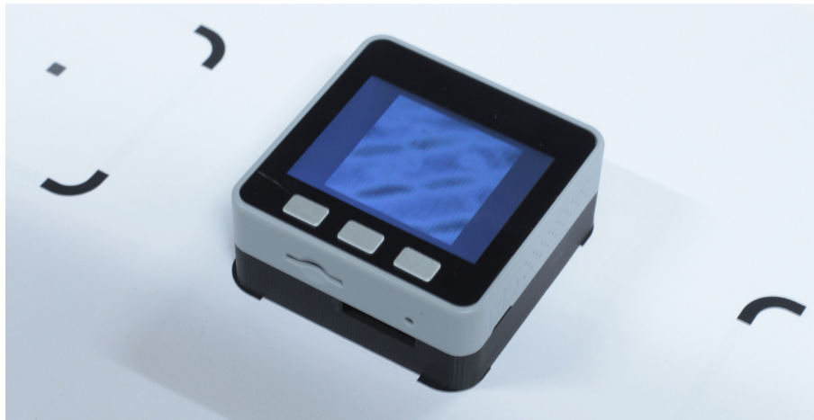
Abbildung 1: DotTrack erlaubt es, die Position eines Tangibles auf einer Oberfläche ohne externe Tracking-Infrastruktur zu tracken. Der Prototyp basiert auf einem M5Stack -Entwicklerboard und einem PMW3360DM -Sensor
