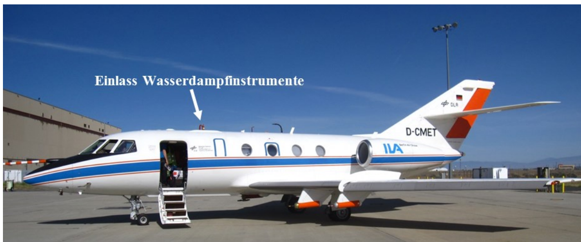
Abbildung 3.3: Position der Einlässe auf dem Flugzeugrumpf der Falcon während der ACCESS-II-Kampagne 2014. Der verwendete Einlass zur Wasserdampfmessung (Abbildung 3.4) befindet sich an vorderster Position.
