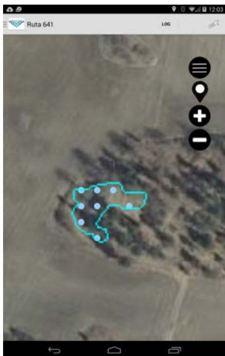
Figur 4. Skärmbild från fältapplikationen Field Pad där både polygon och provytestpunkter är valbara objekt kopplade till inmatningsflöden. Här finns 8 provytor (3 m radie) med 10 m avstånd.
