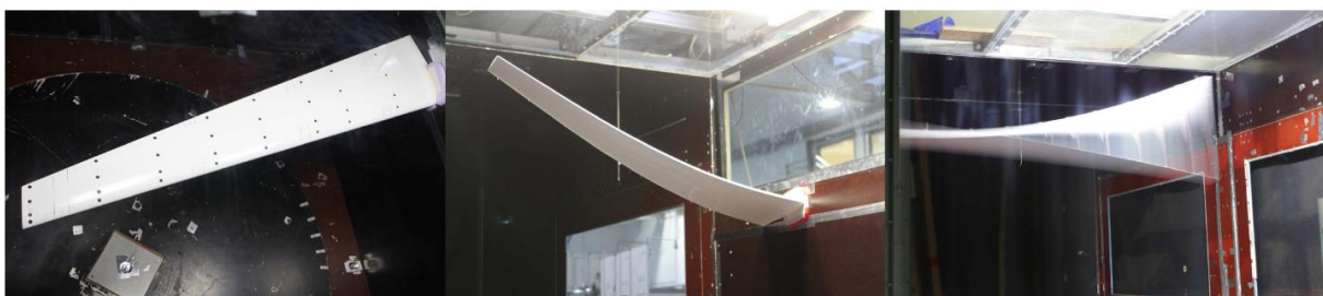
Abbildung 10: ALLEGRA Windkanalmodell für große Deformationen
