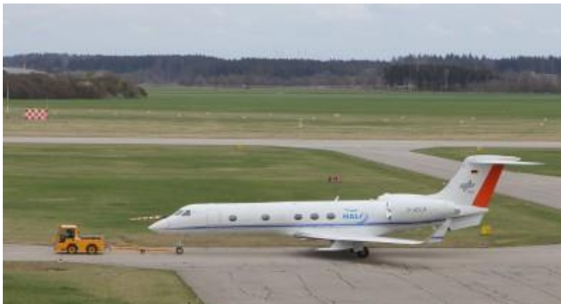
Abbildung 54: Rollversuch der G550 HALO zur Online-Identifikation der Strukturdynamik
