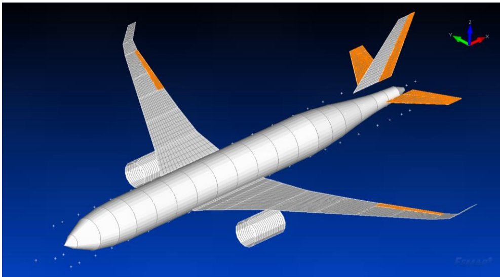
Abbildung 14: Aerodynamisches Modell, Auftriebsflächen als zweidimensionale Paneele, Rumpf modelliert als schlanker Körper mit Interferenzröhre
