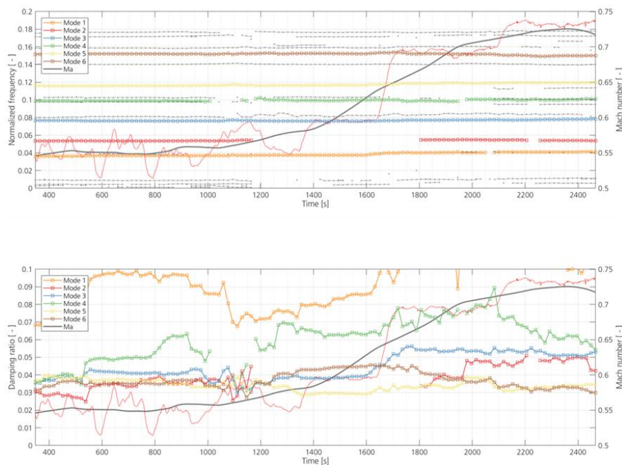
Abbildung 58: Tracking der Eigenfrequenzen (oben) und Dämpfungsmaße (unten) als Funktion der Flugzeit bei Anregung mit natürlicher Turbulenz unter Verwendung des SSI Identifikationsverfahrens
