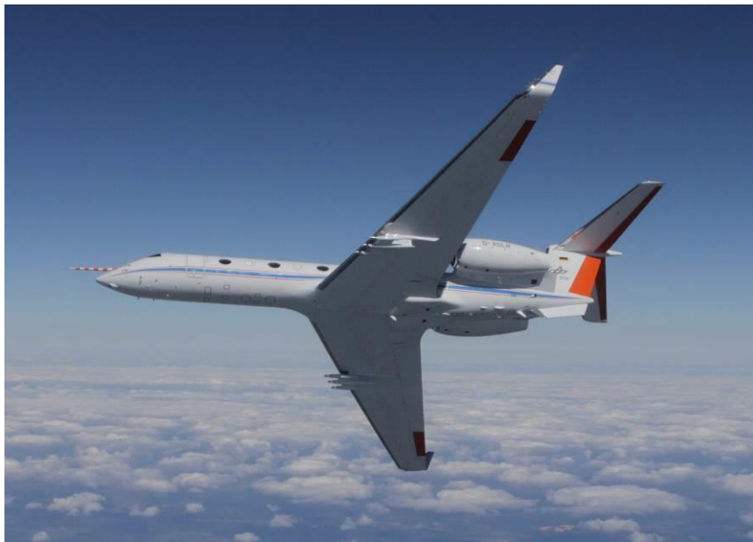
Abbildung 55: Flugversuch der G550 HALO zur Online-Identifikation der Strukturodynamik
