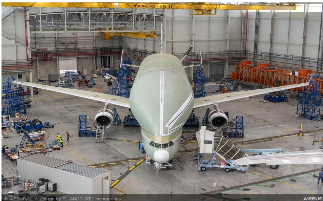
Abbildung 1: Standschwingversuch am Beluga XL, modifiziertes Leitwerk (© Airbus)
