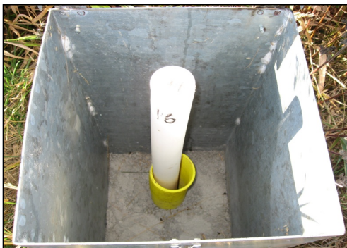
Figur 6. Grundvattenrör. Foto: Maria Blomberg
