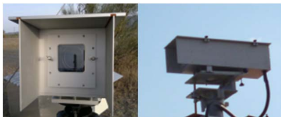
Optec LPV-4 Transmissometer: Transmissionsmessung bei 532 nm über 0.5 bis 20km Lichtweg
