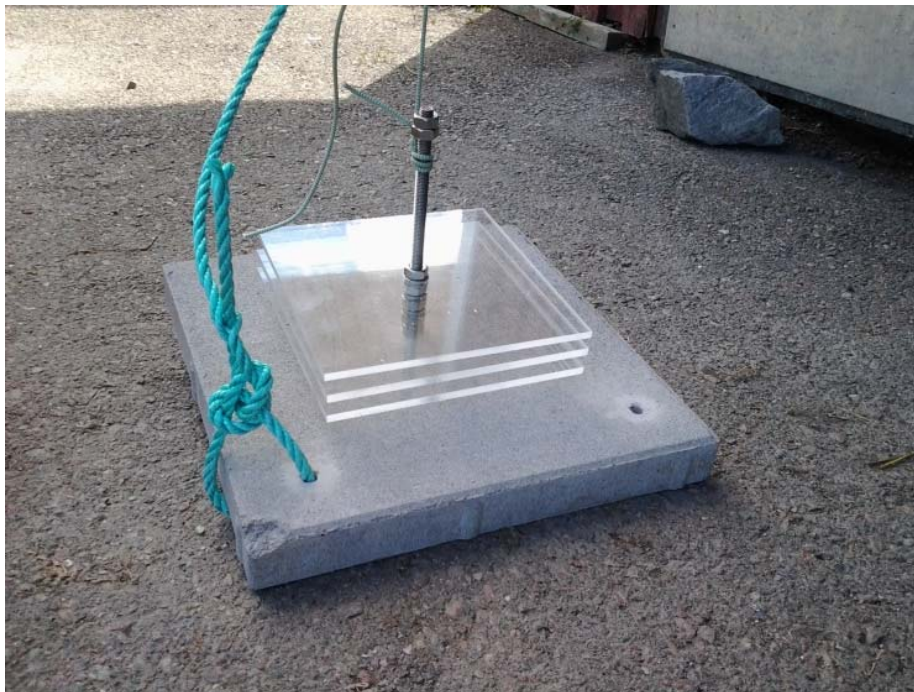
Figur 7. Landforsplatta som används vid provtagning av hårbottenfauna. Åtta stycken Landforsplattor placeras ut vid varje station på cirka fyra meters djup.
