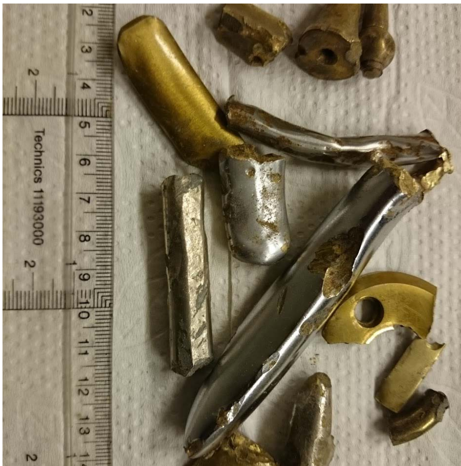
Figur 2. Exempel på metallföreningar som hittades i RT-spånet.
