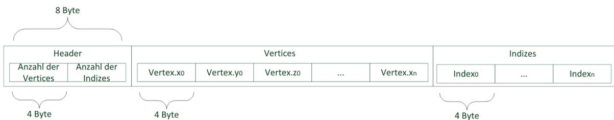
Abbildung 5.13: Binärformat des serialisierten Dreiecksmodells
