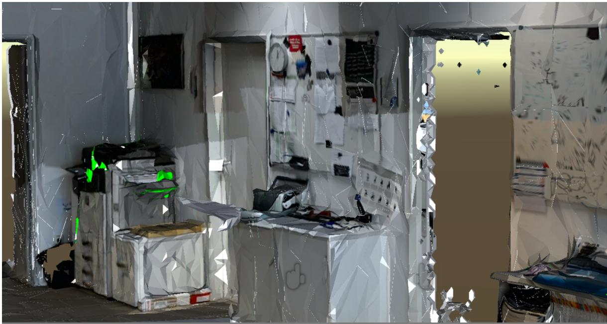
*Abbildung 7.1: Rekonstruktion einer Wand bei einer Texturauflösung von  $1024 \times 1024$  Texeln und einer maximalen Knotendichte von 2000 Knoten pro Kubikmeter*
