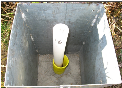
Figur 6. Grundvattenrör. Foto: Maria Blomberg
